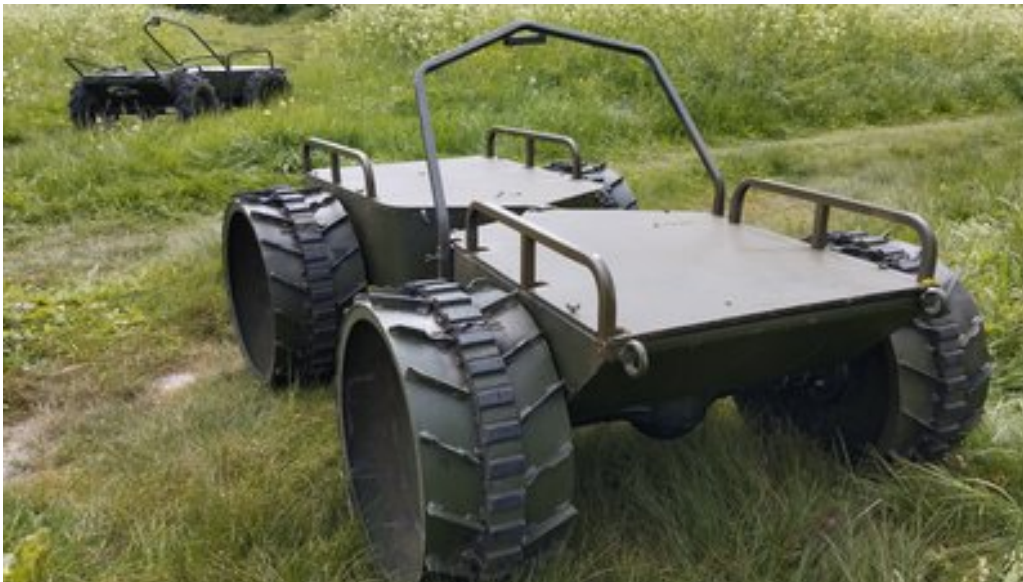
Універсальна наземна роботизована платформа на дистанційному керуванні для військових. Суспільне Полтава
