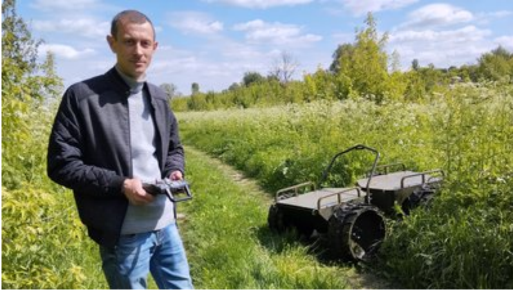
Управляються роботизовані платформи для військових джойстиком. Суспільне Полтава
