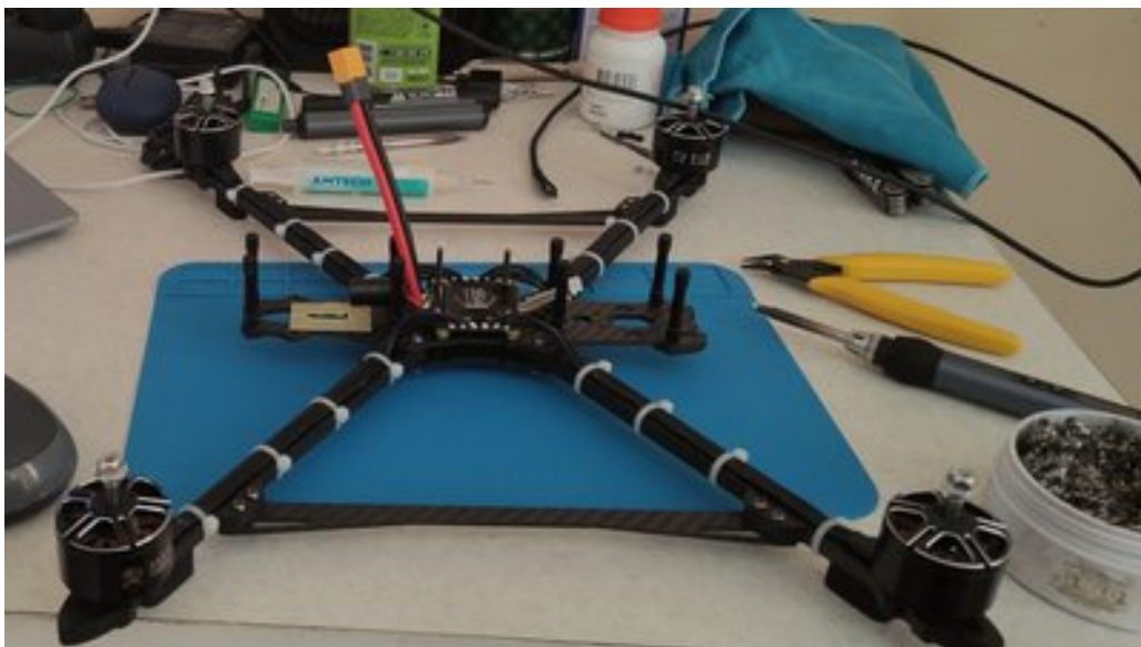
Процес збирання FPV-дрона. Особистий архів Кирила Вакулинського
