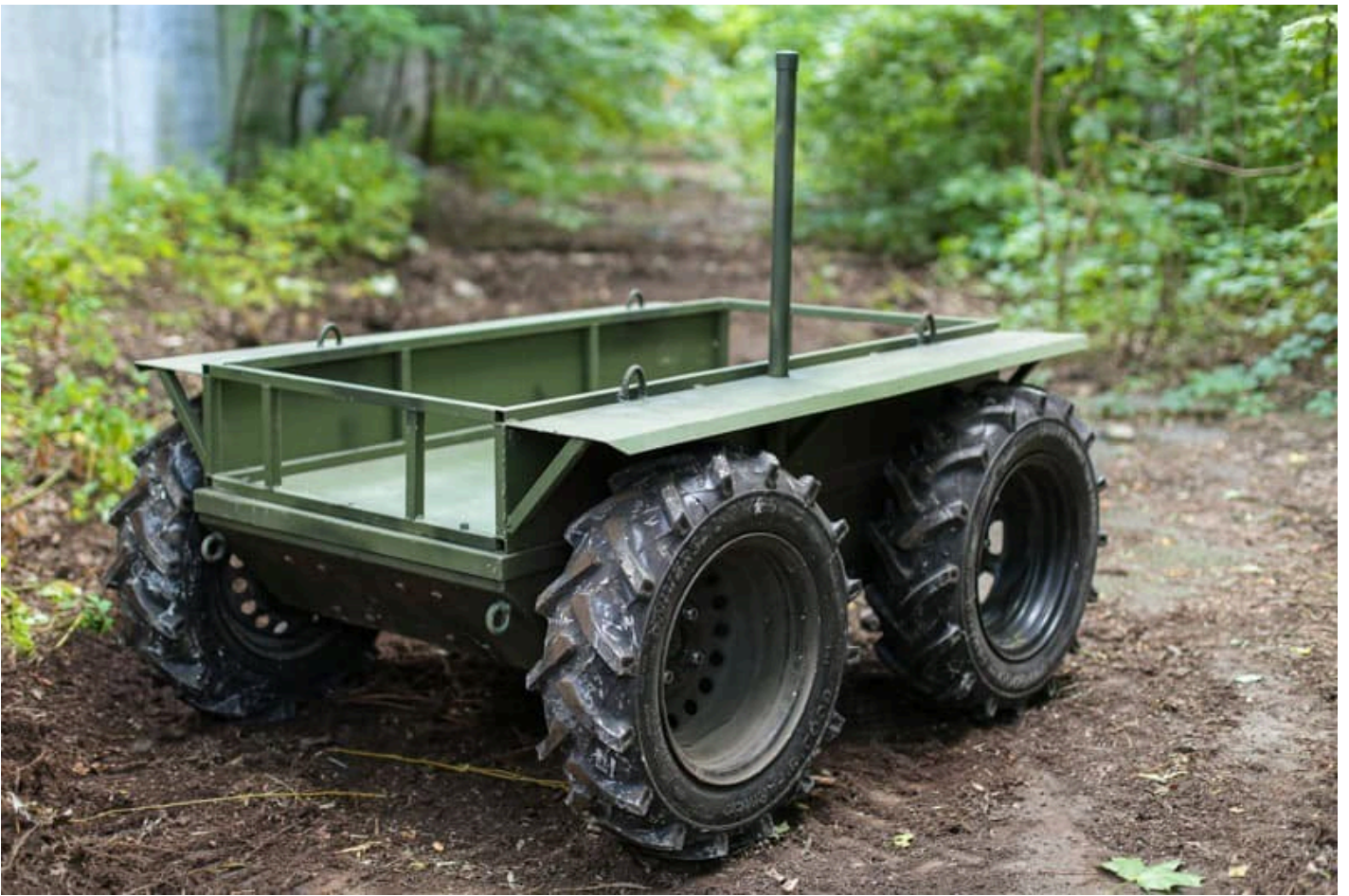
Безпілотний наземний роботизований комплекс Тарган. Фото: Міноборони України Безпілотний наземний роботизований комплекс Тарган. Фото: Міноборони України
